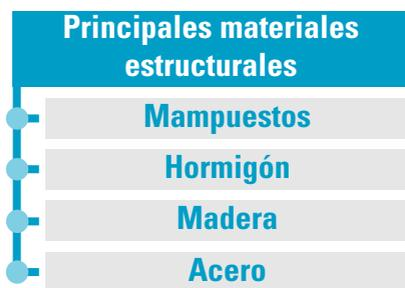
Los **mampuestos** están formados por materiales pétreos de procedencia natural o artificial, unidos o sobrepuestos. Éstos son, junto con la madera, los primeros utilizados por el hombre en sus construcciones. Se caracterizan por tener resistencia y módulo de elasticidad en compresión relativamente altos, y por una baja resistencia a la tracción. La falla es de carácter frágil, tanto en compresión como en tracción.
