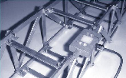
El dispositivo que le proponemos integrar a sus clases como recurso didáctico, si bien está construido con elementos de aluminio, permite analizar estructuras reticulares con miembros unidos entre sí por conexiones.
