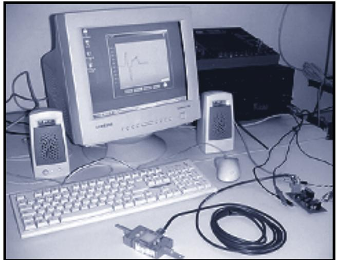
Si la indicación es muy pequeña, podemos aumentar la ganancia de la interface, que consiste en modificar los valores de los *preset* resistivos, que regulan la amplificación de la señal que se obtiene de la celda de carga.
