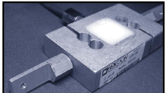
De acuerdo con los cálculos realizados, determinamos que la celda de carga más adecuada para medir las solicitaciones de carga estimadas es un modelo "CZ" -celda de tipo "S" de baja capacidad, 30 kg, en aluminio, para aplicaciones de tracción o compresión-
