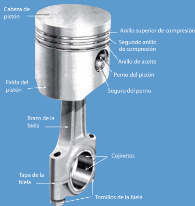
Fig. 1.4: Pistón y biela. La biela transforma el movimiento lineal del pistón en movimiento circular del cigüeñal.
